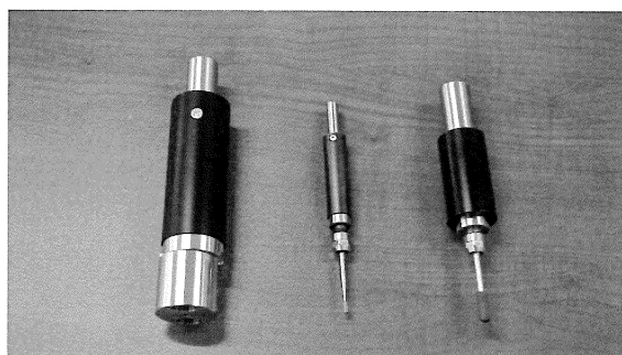
(a) 標準仕様 (b) 小型コレット チャック仕様 (c) 立壁用コレット チャック仕様
