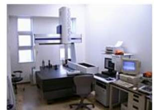
高精度 CNC 三次元座標測定器 測定範囲 800mm × 1000mm (4台)
