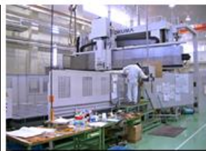
門型マシニング 傾斜アタッチメント付 5面 加工範囲 2500mm × 4800mm
