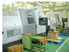
大型 NC 旋盤 加工範囲 φ800
