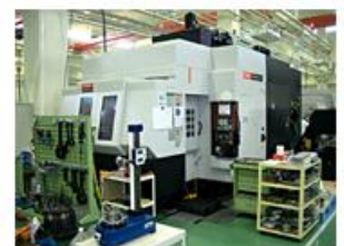
5軸マシニング 2パレット 加工範囲 730mm × 730mm
