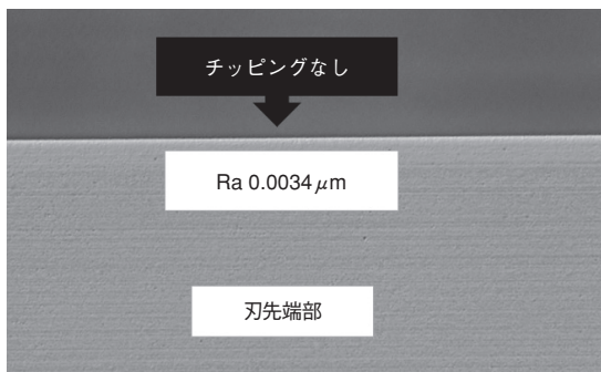
図 6 ELID 研削仕上げり面 (×2,000 倍)
