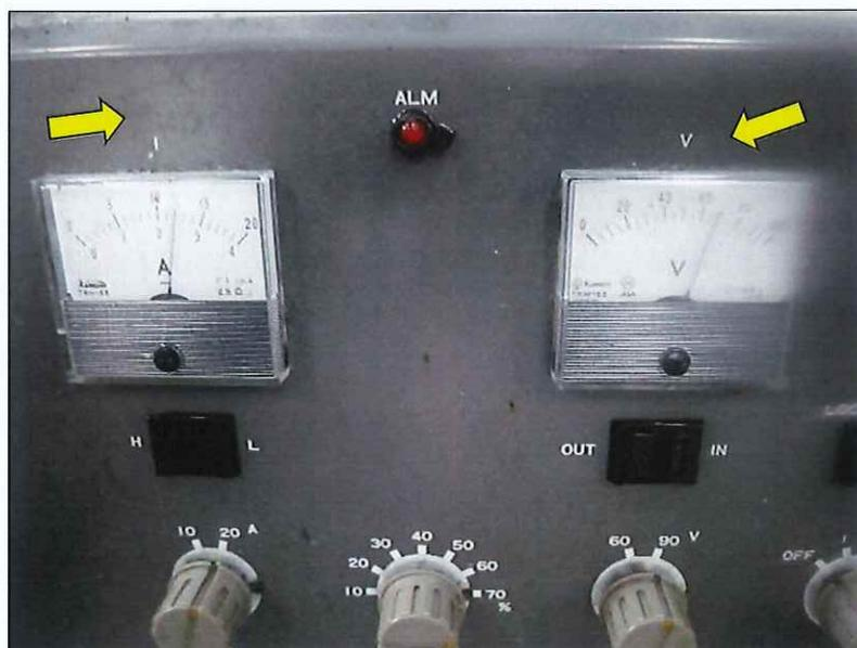
放電ツルーイング中の電流・電圧は、砥石の番手と結合材により異なりますが、電流値が0.8A～4.5Aの間で、放電は推移します。
