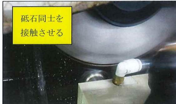
次に、Z 軸目盛りを手動で、0.001mm 単位で、さらに切り込んで行きましょう。すると、0.2mm を過ぎて、0.228mm あたりから、砥石同士が完全に接触して、「ガタガタ」と音を出し始めます。音が出てから、手動でゆっくりと前後テーブルを 2~3 往復させて下さい。すると、下記画像のように、研削液が一瞬「茶色」になり接触音は消えます。これは、表面のゴツゴツした錆が剥がれたからです。
