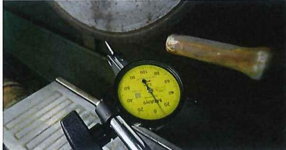
まず、砥石を回転させ、研削液を流して下さい。その次に、電源装置を「ON」にして下さい。
