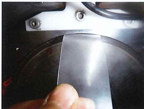
ホ、電解条件は、回転数 800rpm、 $I_p20A \cdot V_p90V \cdot \text{Duty}50\%$ 、所要時間 20 分間です。
