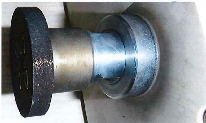
②長期間使用しない場合は、砥石を主轴から取り外し、完全に水分を除去して、ポリ袋に入れて保管して下さい。錆が進行することがありますので、KURE CRC55-6などを塗布すると効果的です。再度使用する際は、有機溶剤で油分を除去して下さい。
