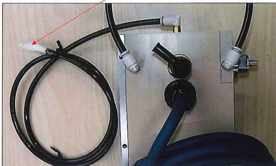
また、ホース先端は水にぬれないようにしてください。もし、水の入ったバケツなどに入れると、エアーを切った時に、水が装置内に逆流する恐れがありますので、充分気を付けてください。
